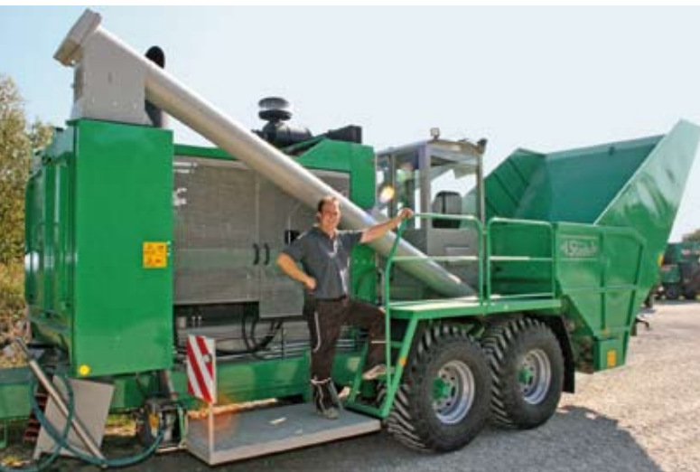
Eine leistungsstarke CCM-Mais-Mühle ist die neueste Errungenschaft im Lohnunternehmen Wolf. Die Maschine kann pro Stunde bis zu 60 t Feuchtmals verarbeiten.
