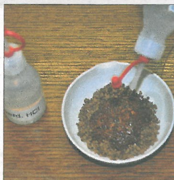
Auch mit dem Salzsäuretest kann man sich einen Überblick über die Kalkversorgung des Bodens verschaffen.
