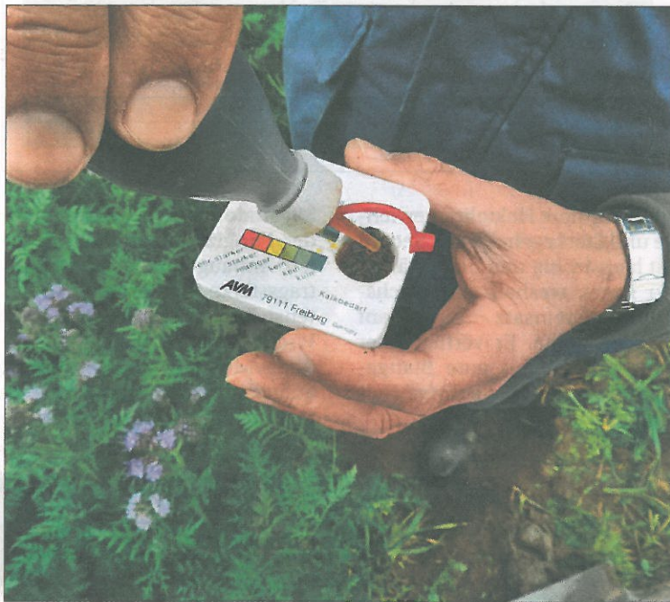
Zuerst den Kalkgehalt prüfen: Das Hellige pH-Meter ist dafür ein altbewährtes Testverfahren und liefert ausreichend genaue Ergebnisse. Zudem ist seine Handhabung einfach und relativ schnell. FOTOS: MAX SCHMIDT
